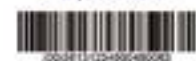
SSCC (Serial Shipping Container Code) avec le numéro de l'unité d'envoi (NVE) encodé dans un symbole GS1-128
